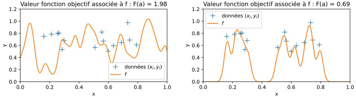
FIGURE 2. Représentation de deux fonctions de la forme donnée dans (1). A gauche les poids  $a_1, a_2, \dots, a_n \in \mathbb{R}$  sont aléatoires, à droite les poids  $a = (a_k)_{1 \leq k \leq n}$  sont bien choisis pour assurer une interpolation satisfaisant nos critères.
