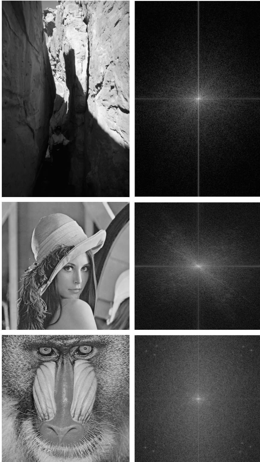
FIGURE 2.15 – Colonne de gauche : images originales. Colonne de droite : spectres d'amplitude centrés des images de gauches, visualisés avec une échelle logarithmique.
